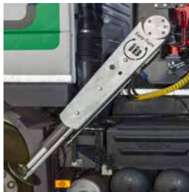
Stabilizzatori telescopici orientabili a 180° automaticamente con sistema "easy turn". Telescopic stabilisers with automatically rotation at 180° with "easy-turn system".
