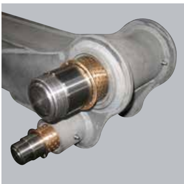
Perneria rettificata di grandi dimensioni, boccole in bronzo alta qualità con canali di distribuzione del grasso che permettono di aumentare i cicli di lavoro della macchina riducendone l'usura. Large size grinded pins and bolts, high quality bronze bushings with canals distribution fat which allow the number of working cycle of the machine to be increased, thus reducing its wear.
