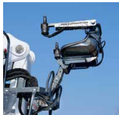
Postazione di comando con joystick proporzionali Parker o Danfoss per montaggio esterno e schermatura contro interferenze. Driver's seat with proportional joysticks Parker or Danfoss to be assembled externally and with anti-interference shielding.
