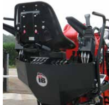
Posto guida centrale con distributore servo-assistito e joystick servo-idraulici. Central driver's seat with servo-hydraulic valve and joystick.
