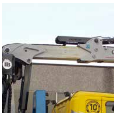
Braccio primario telescopico di nuova concezione per caricatori serie recycling per casse scarrabili. New concept primary telescopic arm for recycling cranes of hooklift box.
