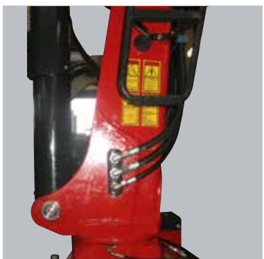
Distributore rotante centrale alla colonna per passaggio interno impianto idraulico e per evitare la rottura delle tubazioni flessibili. Rotating distributor centrally to the column for internal passage hydraulic system to avoid breakage or the pipes.
