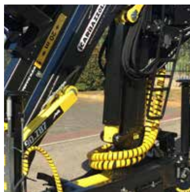
Nuovo sistema di fascio tubi aderenti alla colonna per limitare al minimo l'ingombro e l'usura delle tubazioni. New system bundle hoses adherents to the column for minimize the hoses encumbrance and creep wear.
