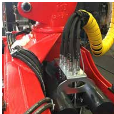
Potente sistema di rotazione a doppia cremagliera in bagno d'olio che permette movimenti veloci con la massima precisione, a sistema di smorzamento di fine corsa. Powerful double track oil-bath rotation system which allows for fast movements with the utmost precision. End of stroke damping system.
