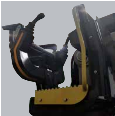
Postazione di comando laterale disponibile con comandi meccanici a leve o joystick e servocomandi in linea o con manipolatori. Side driver's seat available with mechanical levers and joystick or servo-hydraulic in line and joystick.
