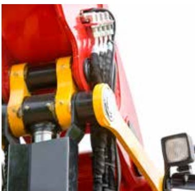
Sistema con biella di potenza per aumentare la forza di sollevamento nel più ampio raggio d'azione. System with driving connecting rod to increase the lifting power for the widest range of action.
