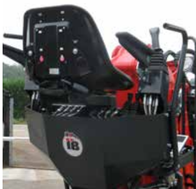
Posto guida con distributore servo-assistito e Joystick servo-idraulici. Driver's seat with servo-hydraulic valve and joystick.
