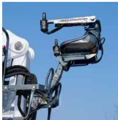
Postazione di comando con Joystick proporzionali Parker o Danfoss per montaggio esterno e schermatura contro interferenze. Driver's seat with proportional joysticks to be assembled externally and with anti-interference shielding.
